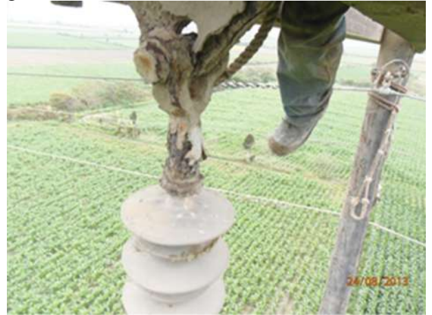
Fig. 3. Herrajes de aislador Polimerico Corroído
